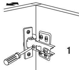
2. La vis de réglage horizontale ajuste la porte vers l'avant ou l'arrière.
